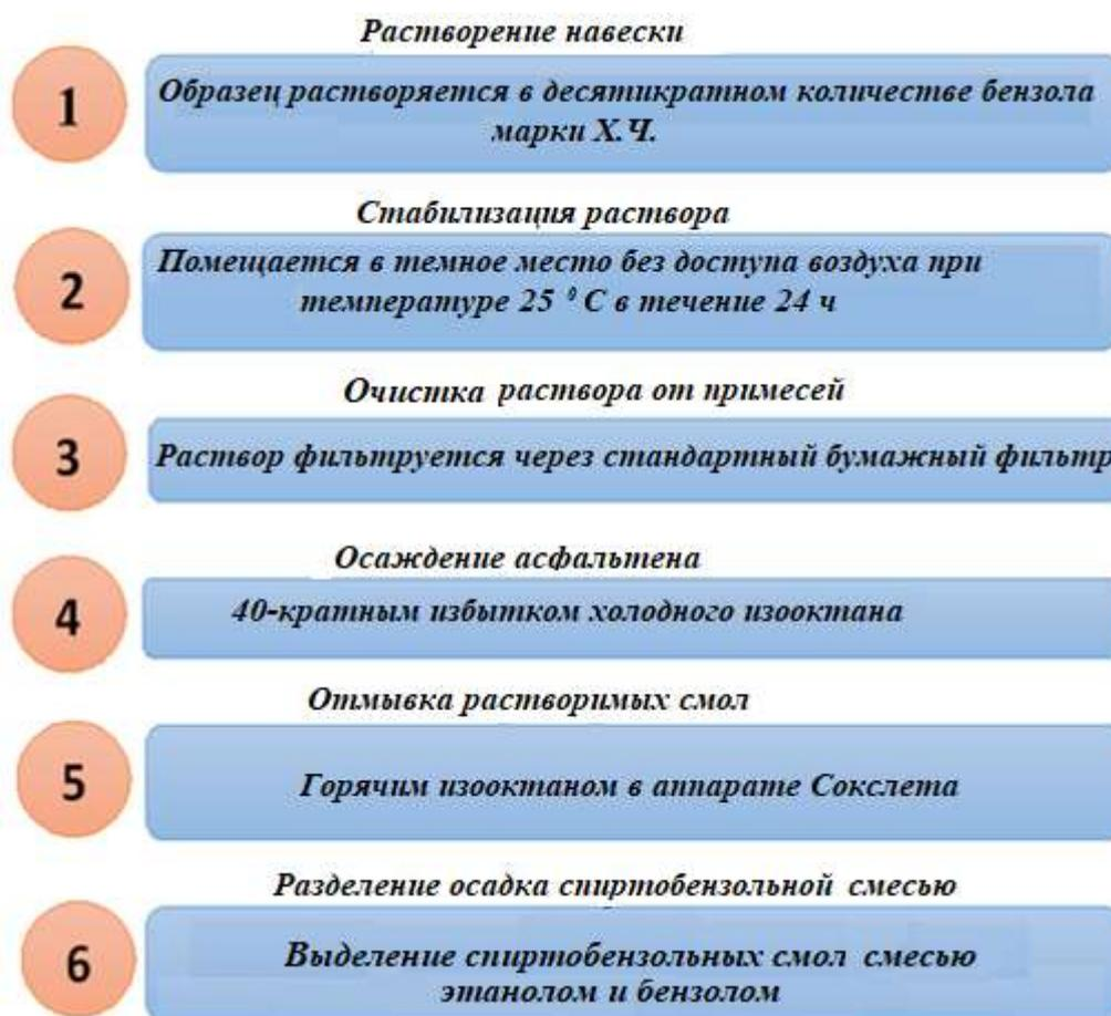
Рисунок 2.1 Схема способа выделения асфальтенов.
