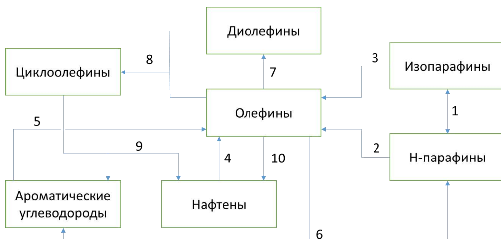
Рисунок 12 – Групповая формализованная схема химических превращений углеводородов, входящих в состав ДФ на цеолитном катализаторе
