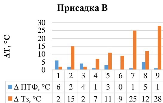
Рисунок 7 – Изменение низкотемпературных свойств образцов прямоугольных ДФ при добавлении присадки В
