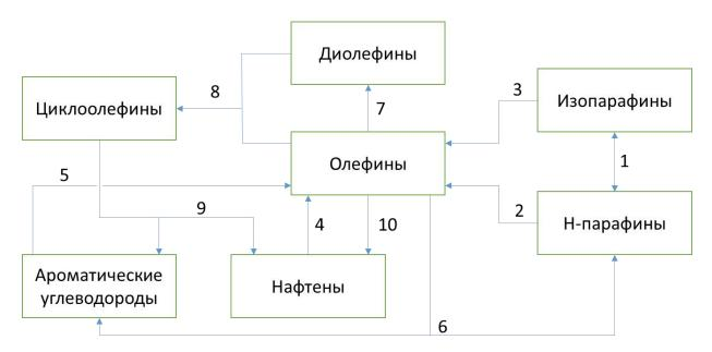
Рисунок 5.1 – Групповая формализованная схема химических превращений углеводородов, входящих в состав ДФ на цеолитном катализаторе
