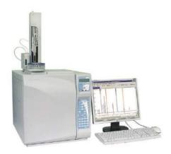
Рисунок 2.7 – Лабораторный аналитический хроматограф «Хроматэк-Кристалл 5000»
