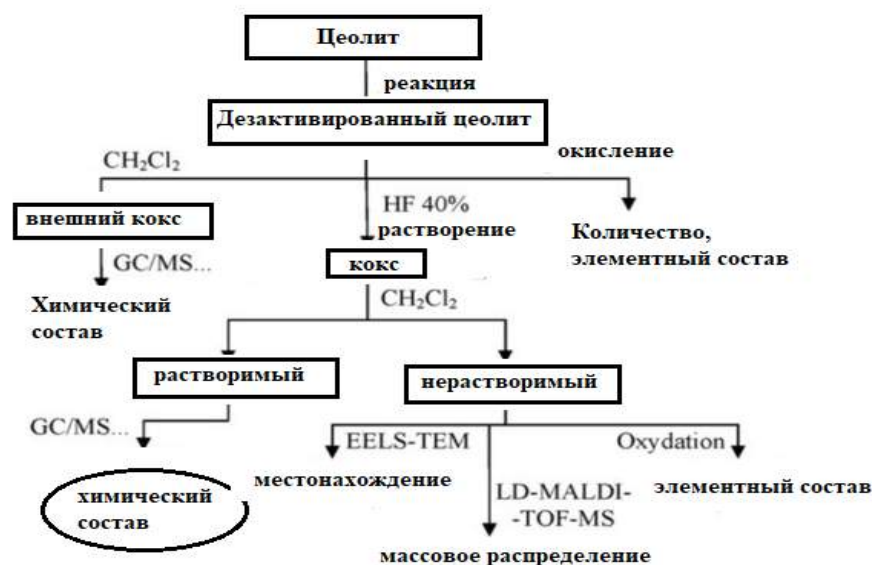
Рисунок 1.25 – Схема определения природы и состава образующегося на цеолите кокса [366]
